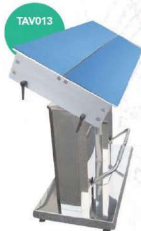
TAVOLO PER ORTOPEDIA MOD. CARLY Tavolo operatorio idraulico a doppia colonna ottagonale idraulica, realizzato in acciaio inox 304. Movimento verticale e trendelenburg azionabile con comando a pedali e movimento laterale manuale che consente al dottore di mettere il paziente in assetto operatorio corretto. Piano a libro RADIOTRASPARENTE e vaschetta assiale raccogli liquidi. Portata 100kg. Dimensioni: L145xP55xH min98 - H max112cm
